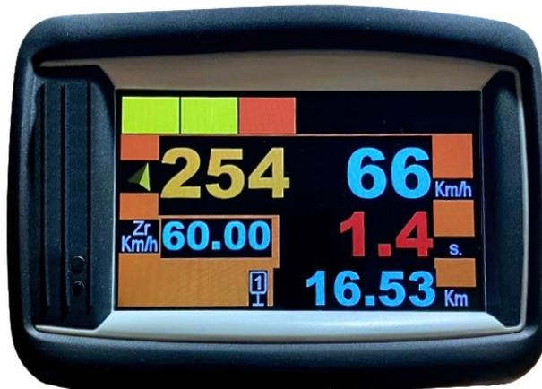
Il est possible d'utiliser un second RR411 « raid » comme « afficheur pilote ». L'intérêt est d'avoir ainsi un **système redondant**. En effet, en cas de défaillance du cadenceur du copilote, l'afficheur du pilote peut prendre le relais en quelques secondes.
