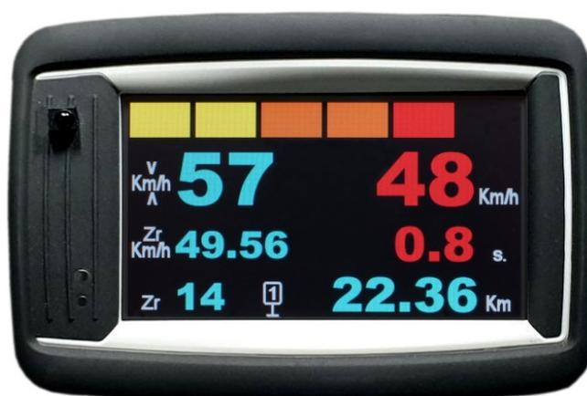
Il est possible d'utiliser un second RR412 comme « afficheur pilote ». L'intérêt est d'avoir ainsi un **système redondant**. En effet, en cas de défaillance du cadenceur du copilote, l'afficheur du pilote peut prendre le relais en quelques secondes.
