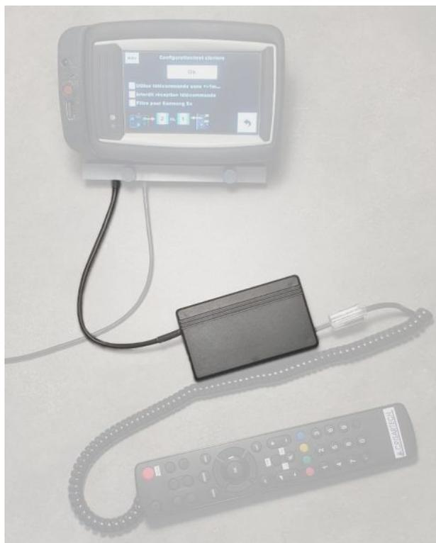
Il comporte un buzzer qui fait « écho » aux appuis sur les touches de la télécommande. Et ce buzzer est aussi actif lorsque l'afficheur demande de rouler plus/moins vite.
