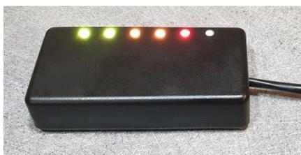
Ce module de **6 leds multicolores** (équivalent à plus de 18 leds) déporté est utilisé pour un affichage « tête haute » sur le pare-brise (**HUD**).
