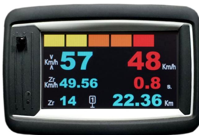
Il est possible d'utiliser un second RR410 comme « afficheur pilote ». L'intérêt est d'avoir ainsi un **système redondant**. En effet, en cas de défaillance du cadenceur du copilote, l'afficheur du pilote peut prendre le relais en quelques secondes.
