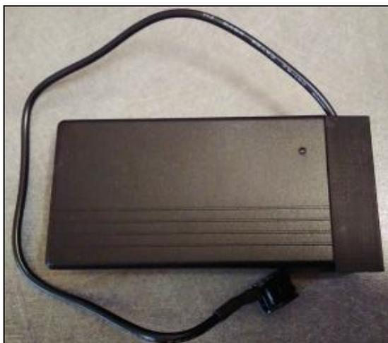
Avec une batterie Li-Ion de grande capacité, cet accessoire permet de faire fonctionner un RR410 avec **environ 3h d'autonomie**. Les utilisations possibles sont :
